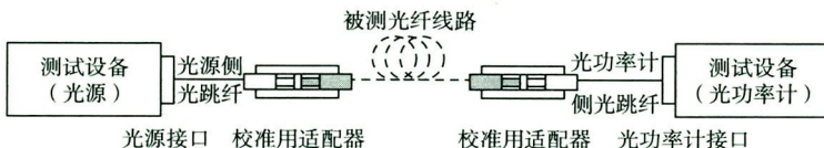
图 A.0.1-2 测试两端为插头的光纤链路
